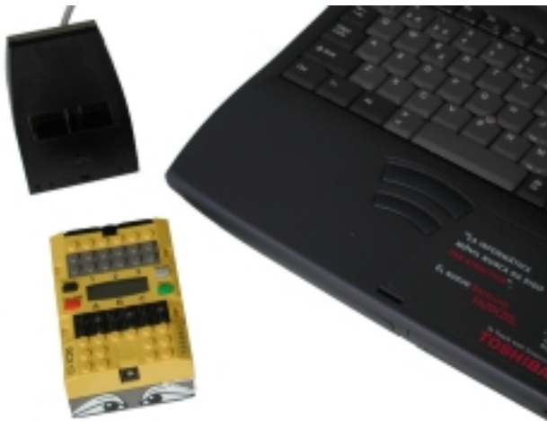
Figura 1.3 Una vez editados los programas, se transfieren al RCX por medio de infrarrojos
